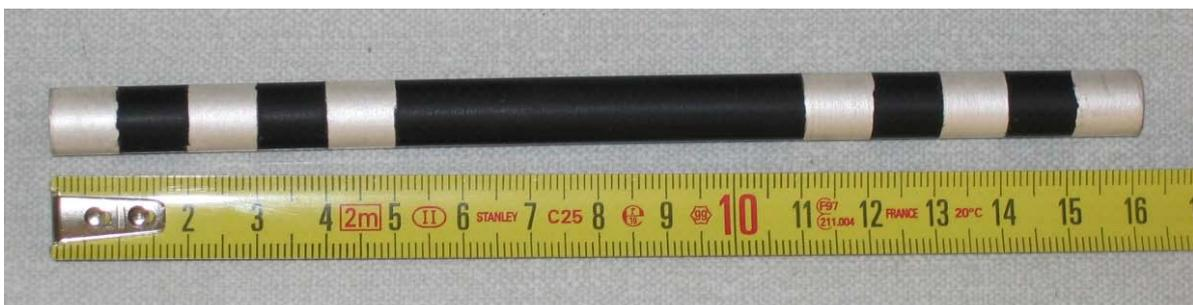
**Figure 3.1** : Photo de l'amenée de courant  $\text{Bi}_{1.8}\text{Pb}_{0.26}\text{Sr}_2\text{Ca}_2\text{Cu}_3\text{O}_{10+x}$  étudiée.
