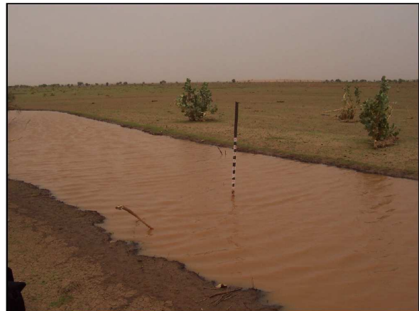
Photo 23 : Repères au centre des tachourts pour estimer la hauteur d'eau
