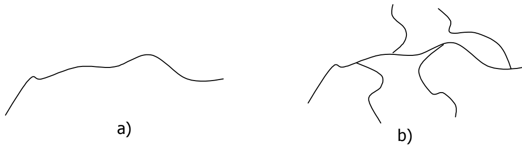
Figure I.10. : Structure a) du HDPE, b) du LDPE.
