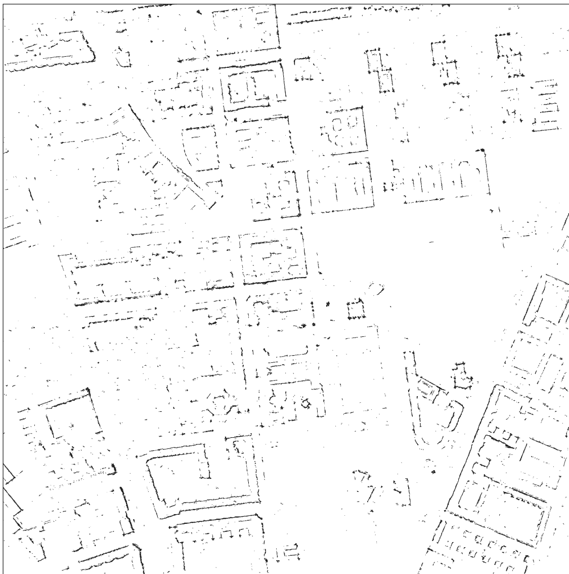
FIG. 7.11 – Reconstruction des points sur les façades des bâtiments. L'image présentée correspond à la carte d'accumulation obtenue après avoir traité toutes les orientations de façade des bâtiments de la scène. Nous pouvons voir qu'une grande partie des façades a été corrigée et que peu de points ont été reconstruits dans les régions correspondant à la végétation.
