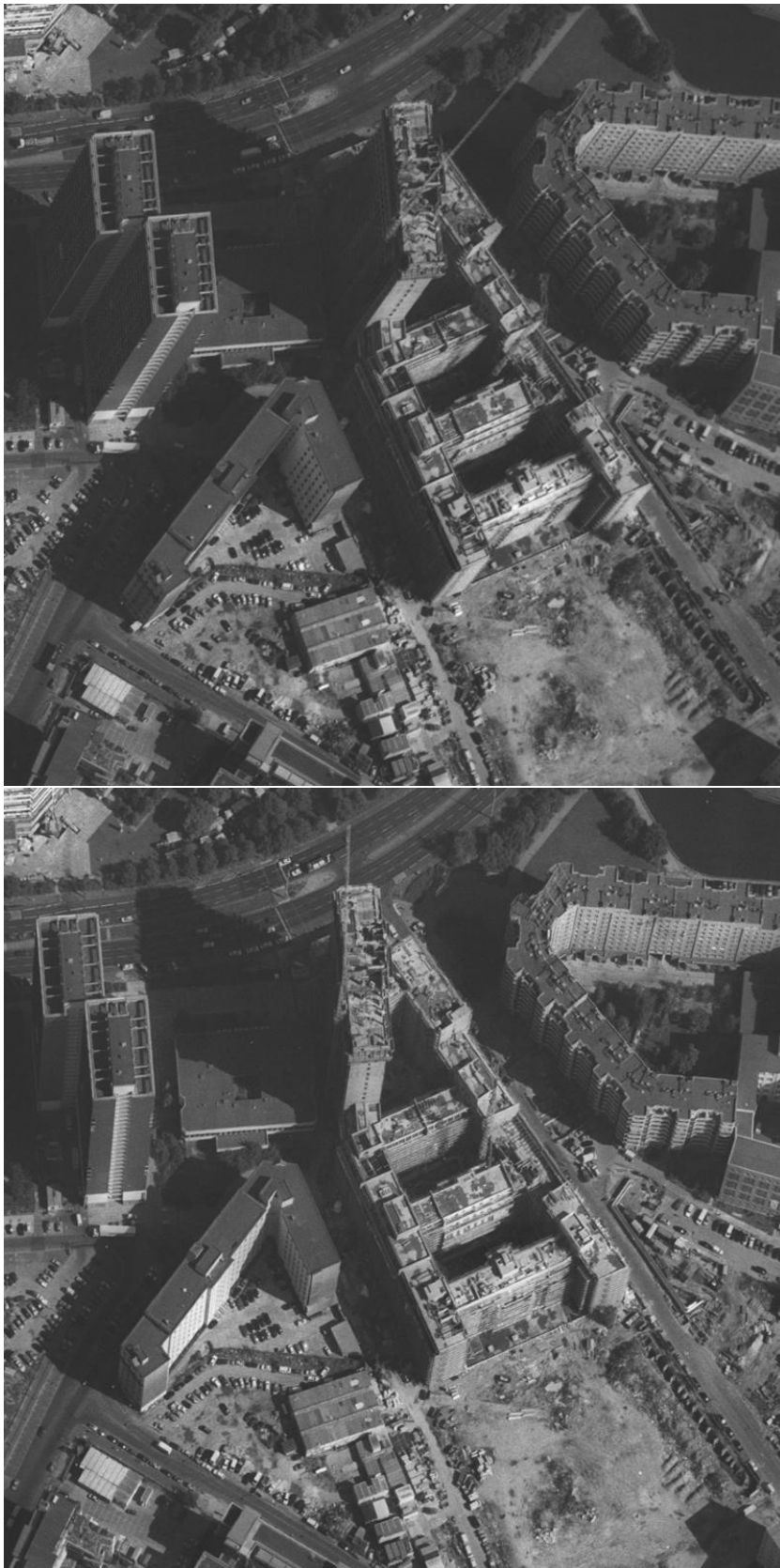
FIG. 4.2 – Cette paire d'images présente les problèmes que nous rencontrons avec les façades. Les surfaces verticales sont déformées et n'ont pas la même taille et orientation dans les différentes vues, ce qui rend leur appariement difficile.
