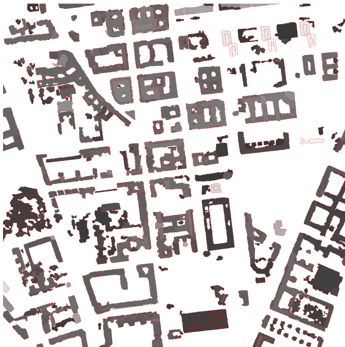
FIG. 7.7 – Construction du modèle polygonal de chaque bâtiment : Présentation du modèle polygonal obtenu, superposé au MNE synthétique utilisé pour la vectorisation. Le modèle représente parfaitement le résultat de la segmentation.
