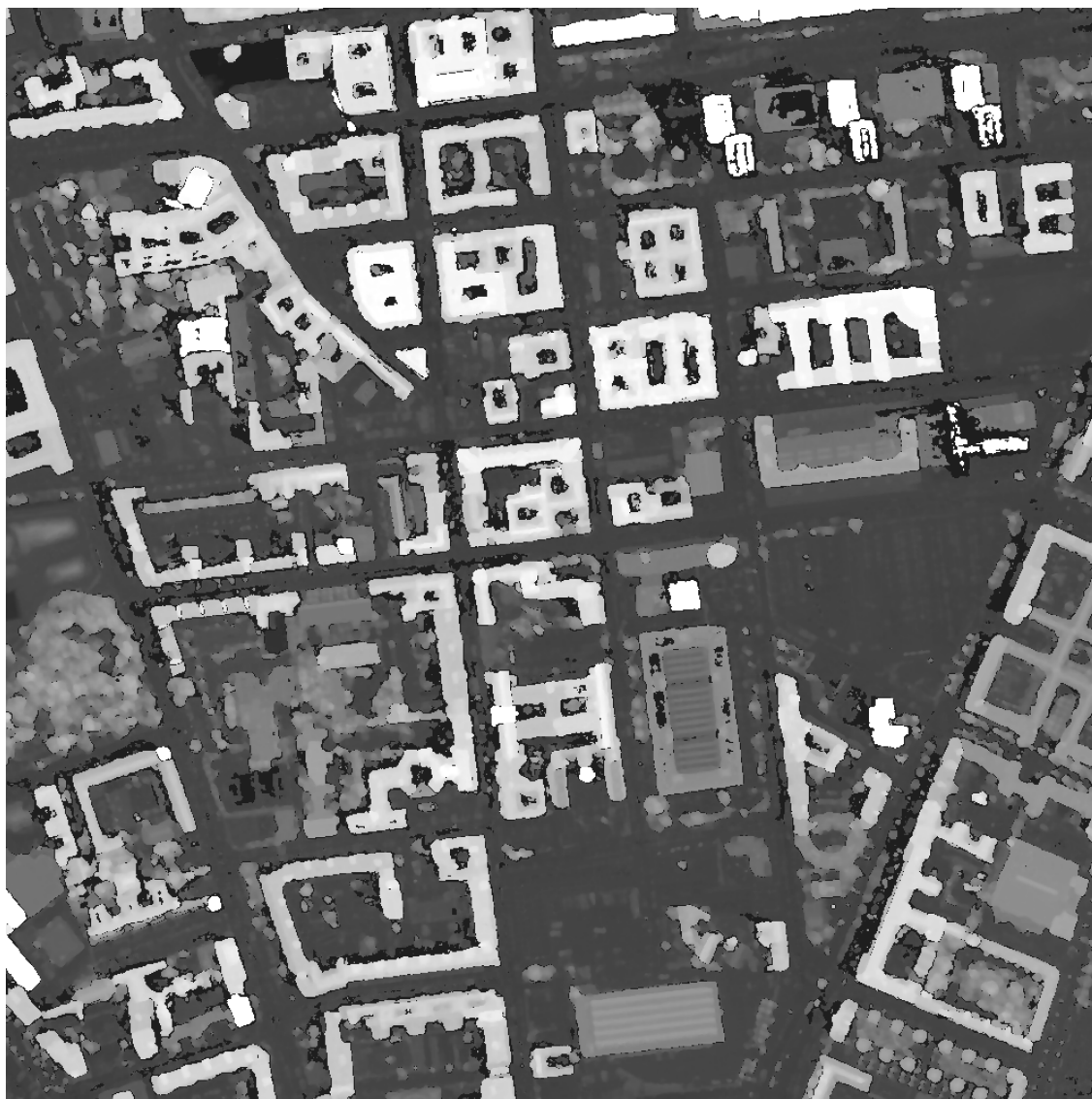
FIG. 7.1 – MNE brut de la scène étudiée : Ce MNE a été reconstruit en utilisant les 24 images disponibles sur le chantier. Dans une première phase, toutes les paires d'images adjacentes sont appariées, elles permettent la construction de MNE locaux. Le MNE brut présenté dans cette figure est obtenu par fusion robuste de tous ces MNE locaux.
