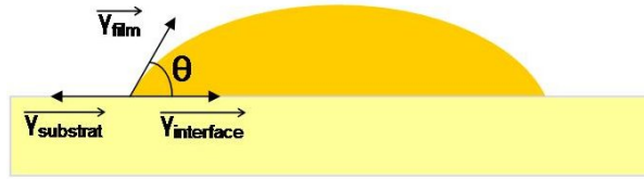
Figure 2.2 – Schéma de la goutte posée sur le substrat à l'équilibre décrit par la loi de Young
