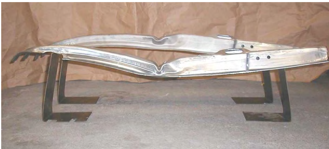
Figure 4 : Test anti-intrusion en cas de choc latéral sur un pied milieu de 306 avant et après traitement thermique. La pièce traitée résiste au test alors que l'autre pièce présente un risque pour le passager
