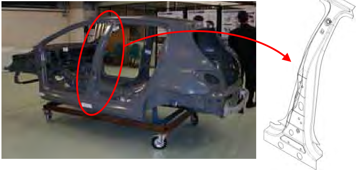
Figure 2 : Pied milieu d'une Peugeot 207
