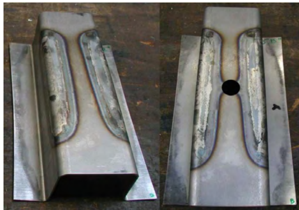
Figure 43 : Effet électromagnétique de bord (antagoniste à l'effet thermique) créé par un trou percé dans une pièce visible après traitement thermique
