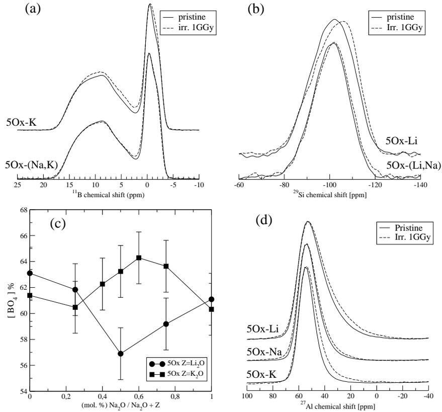
FIG. 3.8 – (a,b,d) Comparaison entre les spectres MAS de verres sains (lignes continues) et irradiés (lignes en tirets) de verres à cinq oxydes [132] ( $\nu_{\text{ROT}} = 12.5$  kHz and  $B_0 = 11.75$  T) 1GGy correspond approximativement à 25% de la dose  $\beta$  totale reçu par la colis durant le stockage. (c) Variation de la fraction des bores en coordinnce 4 en fonction de la composition d'un verre d'alcalin mixte [47].
