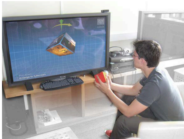
Figure 4 Couplage du cube physique et du cube virtuel. Le cube physique manipulé par l'utilisateur provoque la rotation du cube virtuel présentant une chaîne de télévision sur chaque face.
