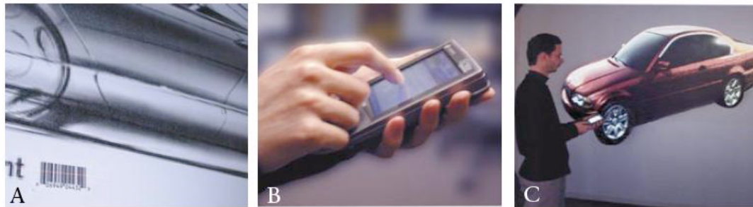
Figure 7 Utilisation du PDA dans Sentient Data Access. Un croquis est équipé d'un code-barres (a) qui est lu par un PDA (b) qui contient dès lors une version numérique du croquis pouvant être déposée sur un mur interactif (c).
