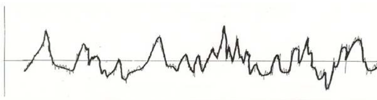
FIG. 2.2 – Effet de la filtration. Le signal turbulent filtré est représenté en gras (cf. C. H. Moeng - NCAR)
