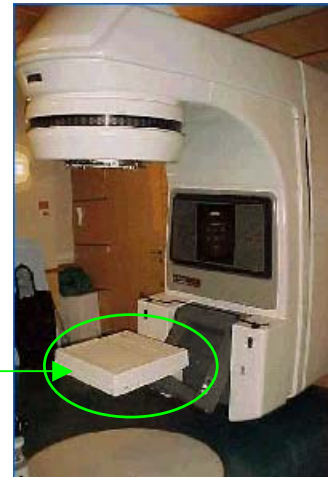
Figure 3. 5 : Système d'imagerie portale électronique utilisé : EPID « aS500 ».
