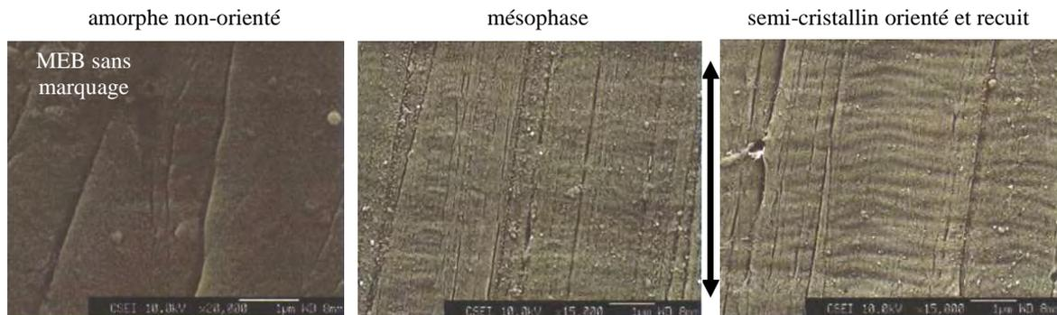
Figure V-29 : Etude MEB haute résolution menée sur des films de copolymères 50 % PET/PEN amorphes isotropes, mésophasés et semi-cristallins non marqués. La double flèche indique la direction d'étirage<sup>[14]</sup>.
