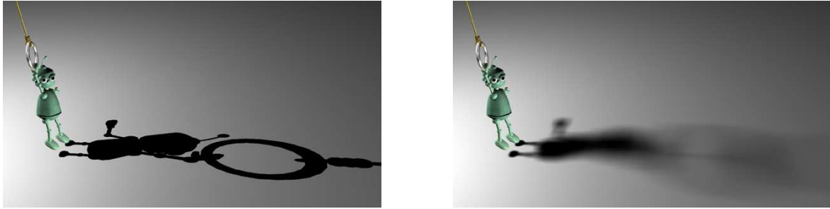
FIG. 1.10 – Ces deux images ont été obtenues par illumination d'un même modèle. L'image de gauche est le résultat de l'éclairage par une source ponctuelle, l'ombre est donc dure. L'ombre de droite est engendrée par une source surfacique. Ces images sont extraites de [55].
