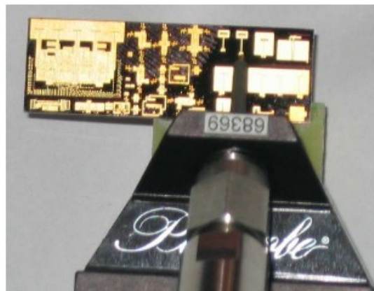
Fig. 139 : Mesure sous pointe d'un élément du WAFER présenté sur la Figure 137
