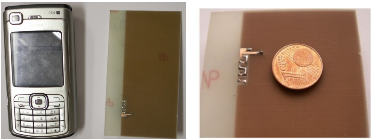
Fig. 162 : Antenne IFA spiralisée réalisée dans une encoche d'un PCB (dimensions 13,2 \times 1,8 \text{ mm}^2 )
