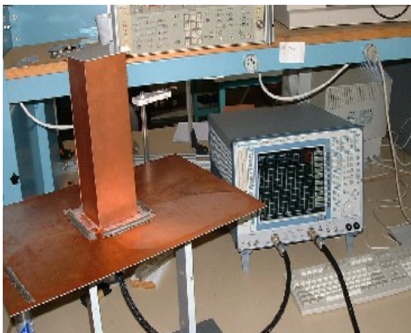
Mesure de l'antenne dans la Wheeler Cap
