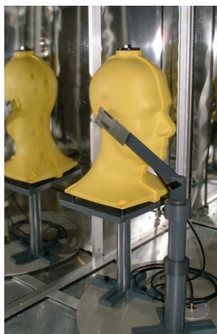
Fig. 68 : Photo de la mesure d'un système multi-antennaire en présence d'une tête (fantôme) dans la chambre réverbérante Bluetest
