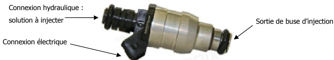
Figure 1.23 Représentation d'un injecteur Bosch EV6
