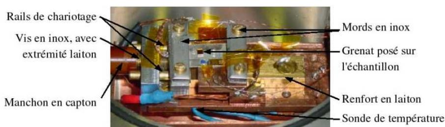
Figure 4.11 *Le dispositif de mise sous traction ; la contrainte est transmise par une vis en inox débouchant. Les mords (2\*5\*20mm) sont couverts de papier de verre P300 pour éviter le glissement de l'échantillon lors de la traction*
