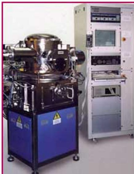
FIG. II.18 – Photographie du bâti de métallisation par évaporation
