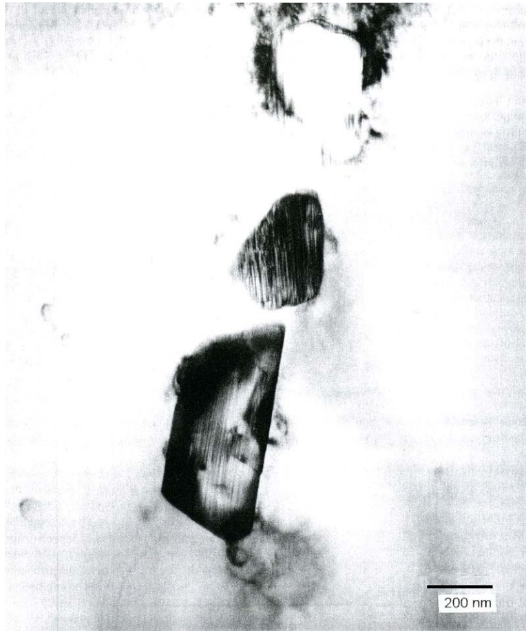
Figure I.13 : Microstructure des précipités Zr(Cr, Fe)_2 , d'après [IAEA-98]
