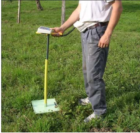
Figure 21. Un herbomètre (Fabrication ITCF) (Cliché : T. Maradan).
