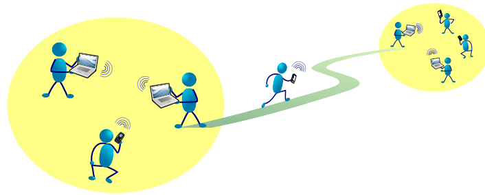
FIG. 3.4 – Détail illustrant le transport de messages par un terminal mobile se déplaçant entre deux îlots constitué chacun de quelques terminaux
