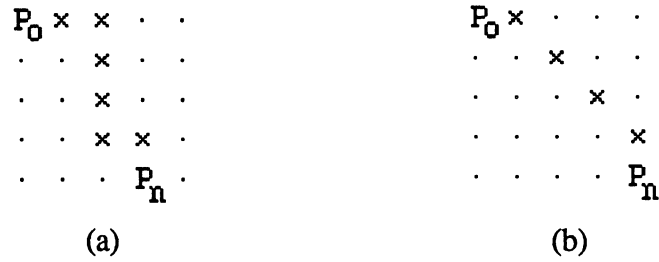
Figure 2.8. Chemin connexe entre P_0 et P_n selon d_4 (a) et selon d_8 (b).
