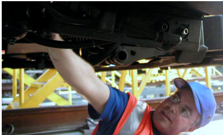
FIG. 4.1 – Position de l'opérateur pendant une des phases de maintenance
