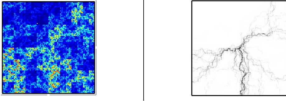
Figure 11 : à droite : grille multifractale. À gauche : flux permanent dans la grille avec un pompage au centre.
