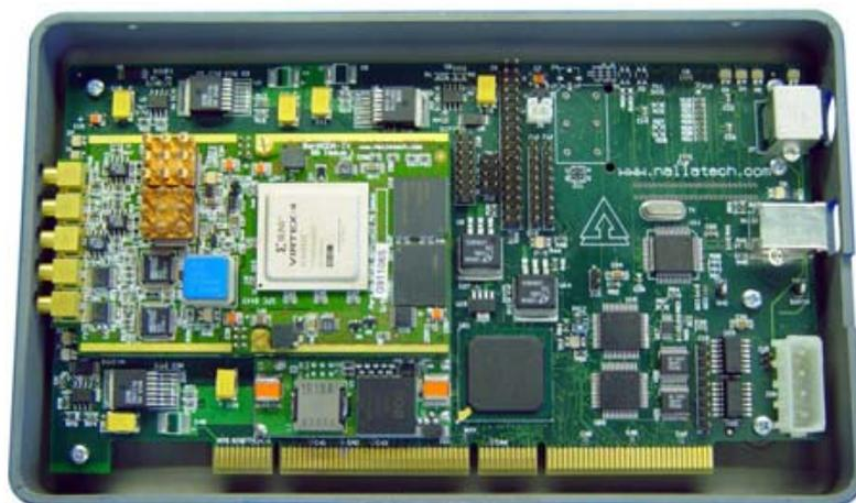
FIG. 2.10 – Kit de développement XtremeDSP pour Virtex-4.
