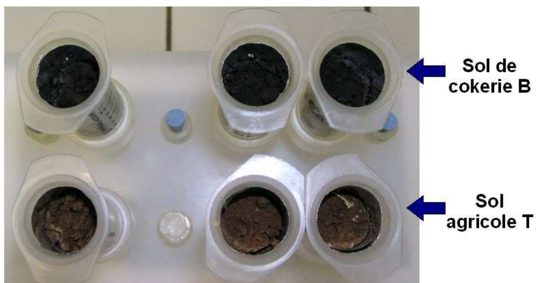
Figure 58 : Photos de micro-colonnes du sol agricole T et du sol de cokerie B après leur percolation. a) vue de devant, b) vue de dessus
