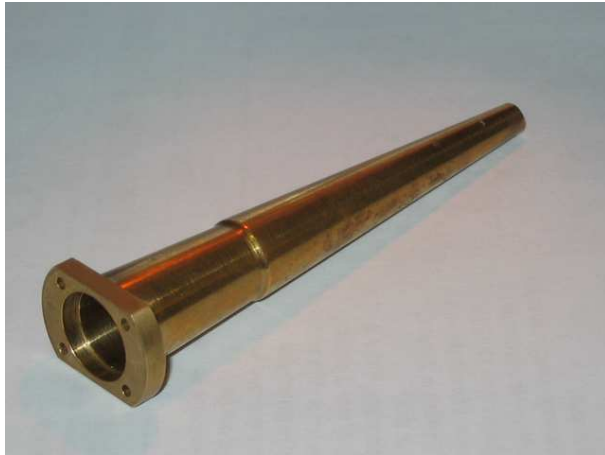
(a) Image du guide d'onde conique qui focalise les micro-ondes sur un cercle de diamètre d = 4 \text{ mm} (« setup I »).
