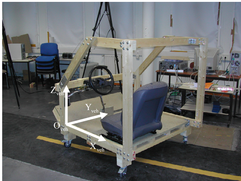
Figure 3.19 : repère (O_{veh}, \vec{X}_{veh}, \vec{Y}_{veh}, \vec{Z}_{veh}) véhicule et la maquette.
