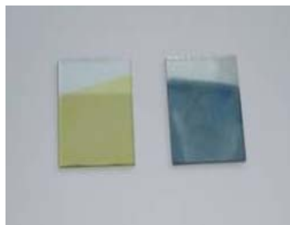
Fig. 4.6. Films de poly( 28 ) déposés sur ITO à l'état neutre (jaune) et à l'état oxydé (bleu)
