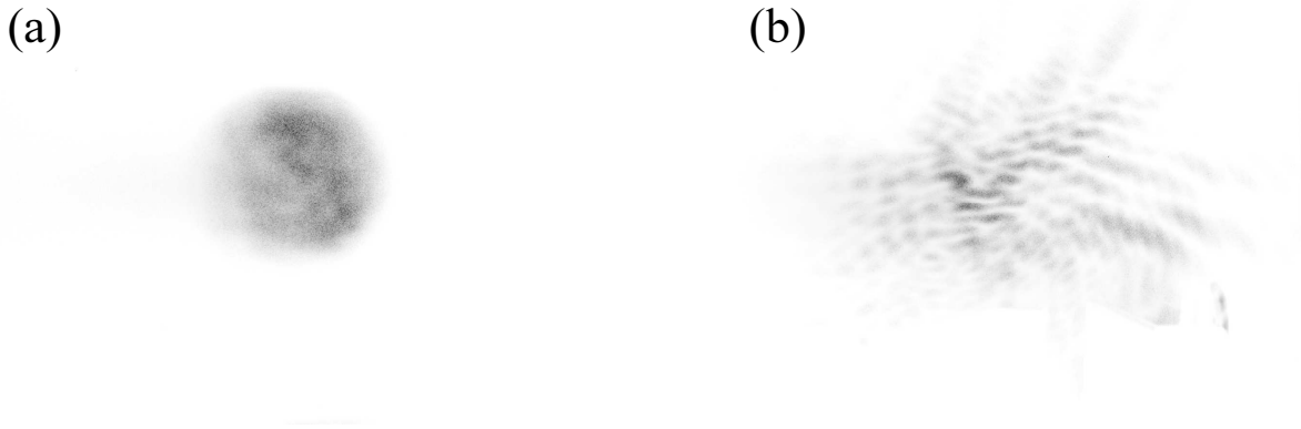
Fig. 3.3: Profil spatial du laser LUCA après réflexion sur le plasma pour deux éclaircements. En (a) l'éclaircissement est de 4 \times 10^{16} W cm^{-2} , en (b) de 7 \times 10^{17} W cm^{-2} .
