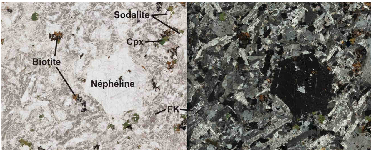
Fig. 85 : Photos en lumière naturelle et polarisée-analysée de la syénite peralcaline 05-M-82. On distingue la néphéline automorphe, les baguettes de feldspath alcalin, le clinopyroxène vert et la biotite brune. Largeur des photos : 1 cm.
