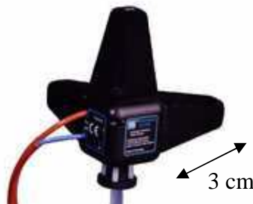
FIG. 2.8: Sonde de champ triaxiale (Hi6005) utilisée pour la mesure des trois composantes cartésiennes du champ électrique.
