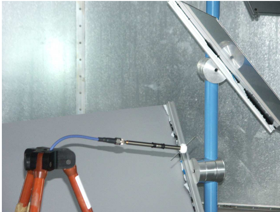
FIG. 9.3: Dipôle dont on souhaite caractériser l'efficacité de rayonnement par une mesure en chambre réverbérante à brassage de modes.
