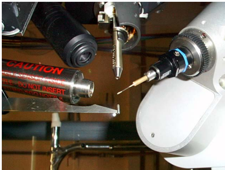
Fig. 2: Appareil CCD à quatre cercles
