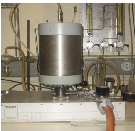
Fig. 9 : Appareil DSC NETZSCH ATD-DSC 404S
