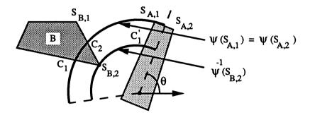
Figure 6.1: Calcul des points de contact d'un objet en rotation.
