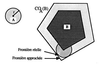
Figure 6.5: Grossissement circulaire d'un obstacle polygonal.
