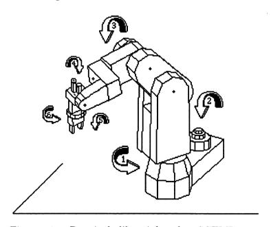
Figure 10.1: Degrés de liberté du robot SCEMI.
