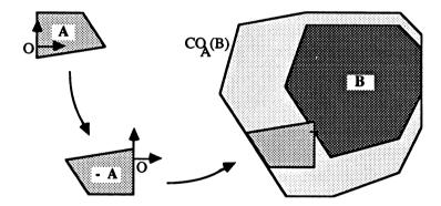
Figure 6.4: Grossissement bidimensionnel d'un obstable polygonal.
