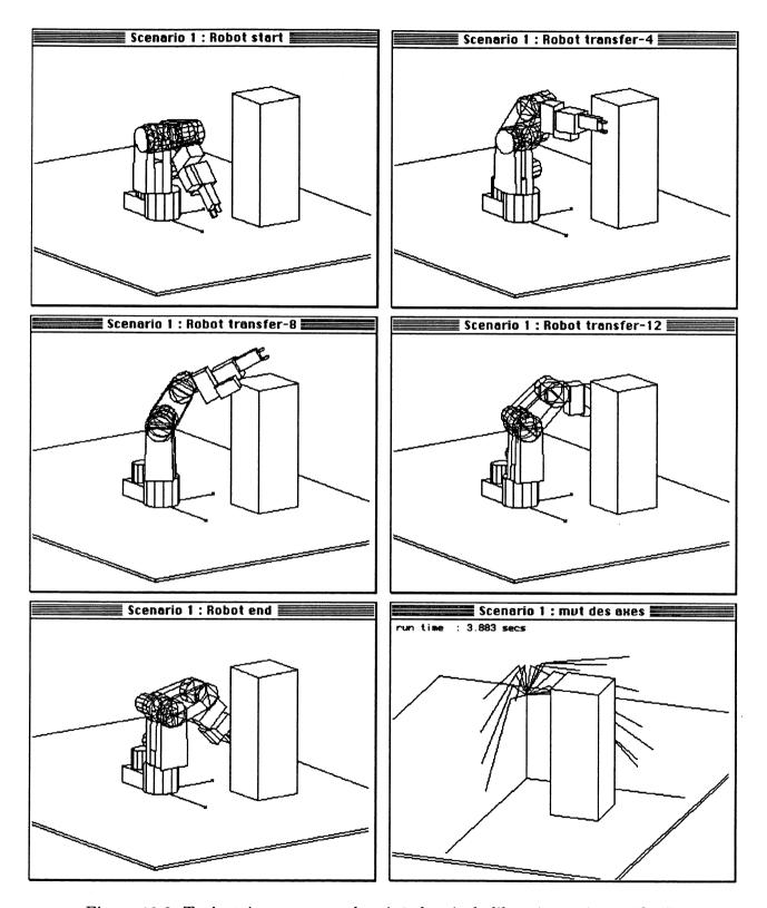
Figure 10.3: Trajectoire pour un robot à 3 degrés de liberté et poignet "figé".
