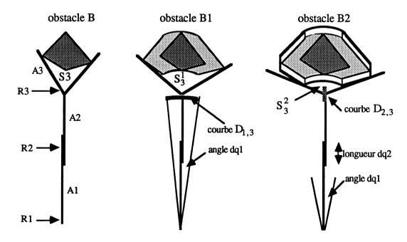
Figure 6.9: Propagation des contraintes de position d'une structure articulée.
