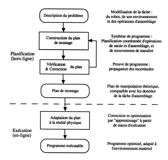
Figure 2.2: Architecture fonctionnelle du système SHARP.
