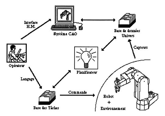
Figure 2.1: Cellule de CFAO robotique.
