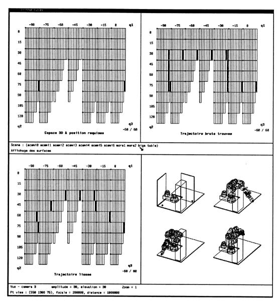
Figure 7.2: Exemple de détermination d'une trajectoire.
