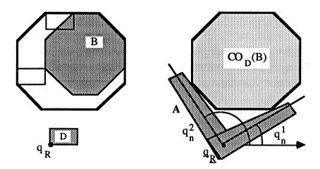
Figure 6.6: Calcul des contraintes d'orientation conjointes.
