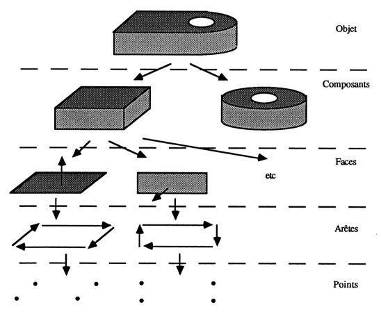
Figure 4.2: Structure topologique d'un objet.
