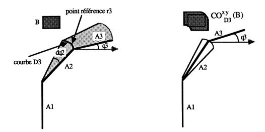
Figure 6.8: Calcul des contraintes de débattement d'un élément de  $\mathcal{A}$ .
