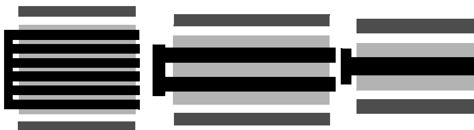
Figure 3-4 : Trois layouts différents d'un même dispositif pour le nombre de doigts de grille.
