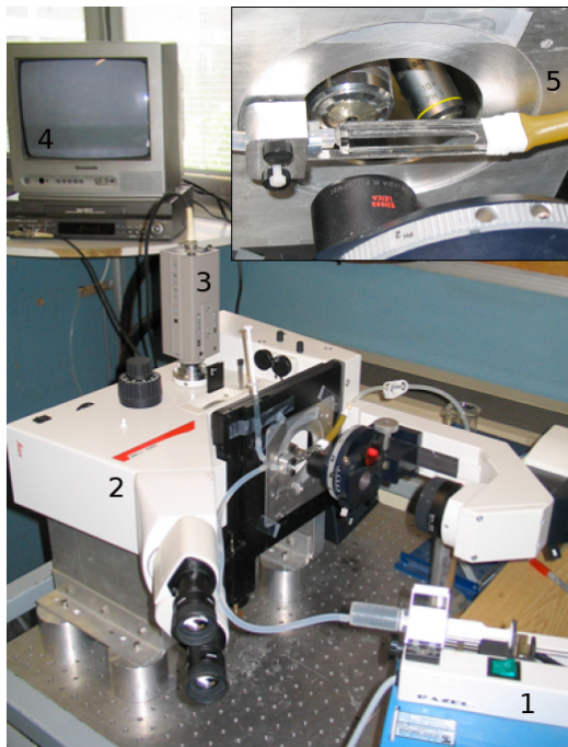
FIG. 6.6 – Le microscope couché permet une visualisation dans un plan parallèle à la gravité et au plan de cisaillement. 1 : Pousse-seringue, 2 : Microscope couché, 3 : caméra, 4 : téléviseur, 5 : Zoom sur la chambre d'écoulement.
