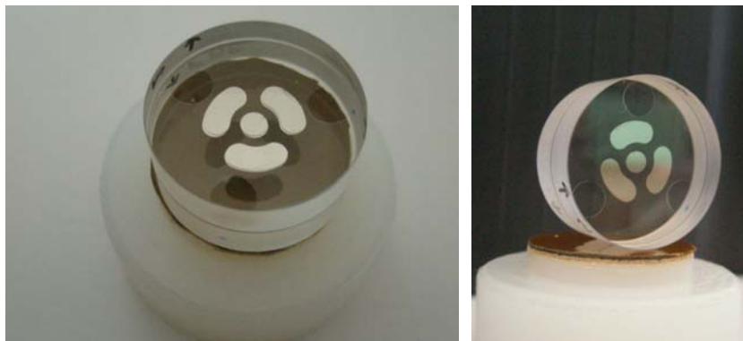
Figure 109 : Photographie des deux lames adhéérées. L'objet ainsi obtenu est un interféromètre de Fabry-Perot présentant une épaisseur mécanique de cavité de 86 \mu\text{m} .
