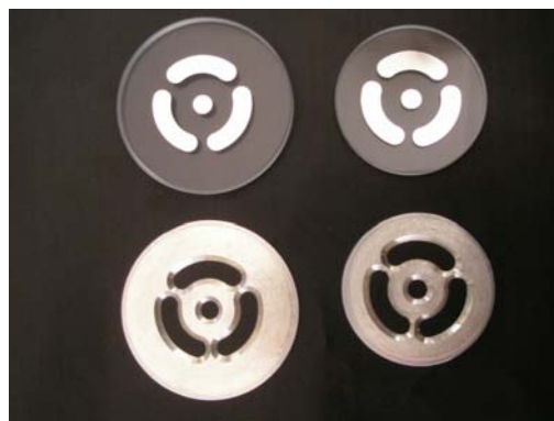
Figure 88 : Photographie des masques destinés au dépôt métallique (en bas) et résultat du dépôt obtenu sur des lames de diamètre 30 mm et 25 mm (en haut).
