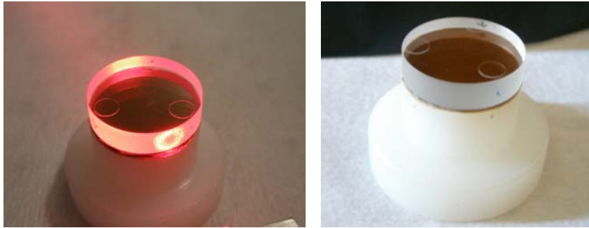
Figure 107 : Photographie des plots adhéérés en ULE sur la lame, avant traitement (la couleur rougeâtre est due à un éclairage à l'aide d'un laser He-Ne afin de mieux visualiser les plots).
