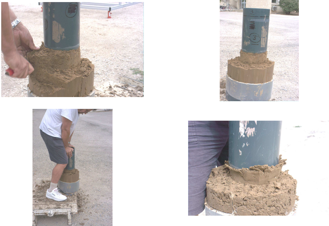
Figure III.2.3 : Le prélèvement de la colonne L (15 cm diamètre, 25 cm hauteur) à partir d'un lysimètre (25 cm diamètre, 70 cm hauteur). La colonne L est enfoncée à fur et à mesure après avoir débarrassé du sol qui l'entoure.
