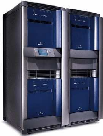
FIG. 7.4 – L'ORIGIN 2000 à 32 processeurs du Pôle Parallélisme Ile-de-France Sud
