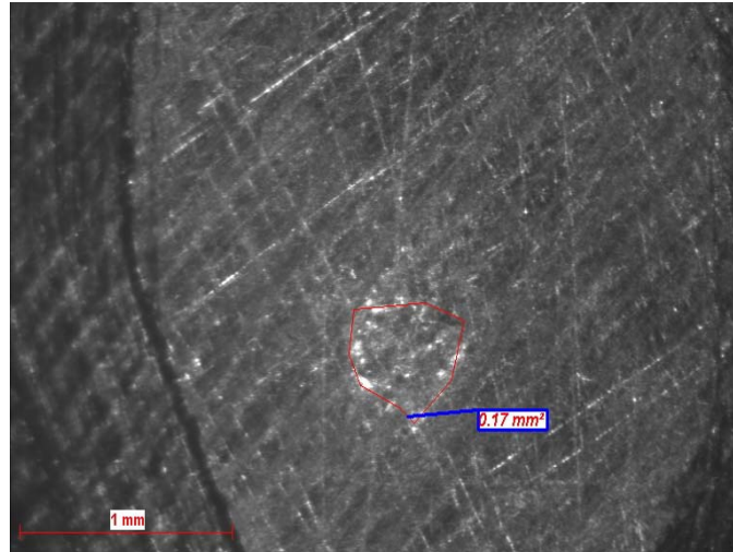
Figure 52 : Exemple d'impact de claquage sur le plateau côté masse.
