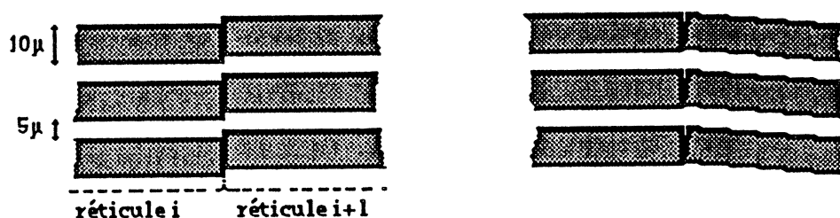
Figure 3.6 : conséquences d'un chevauchement ou d'une rotation d'un réticule
