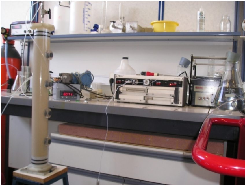
FIG. 6.13: Dispositif de la mesure de la conductivité à saturation.
