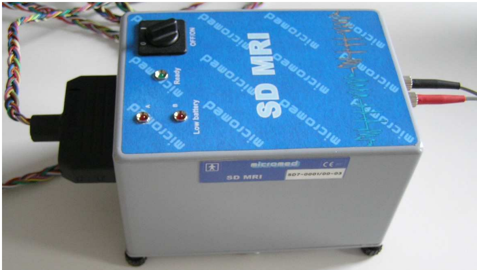
Fig. 6.4 : Amplificateur compatible IRM.
