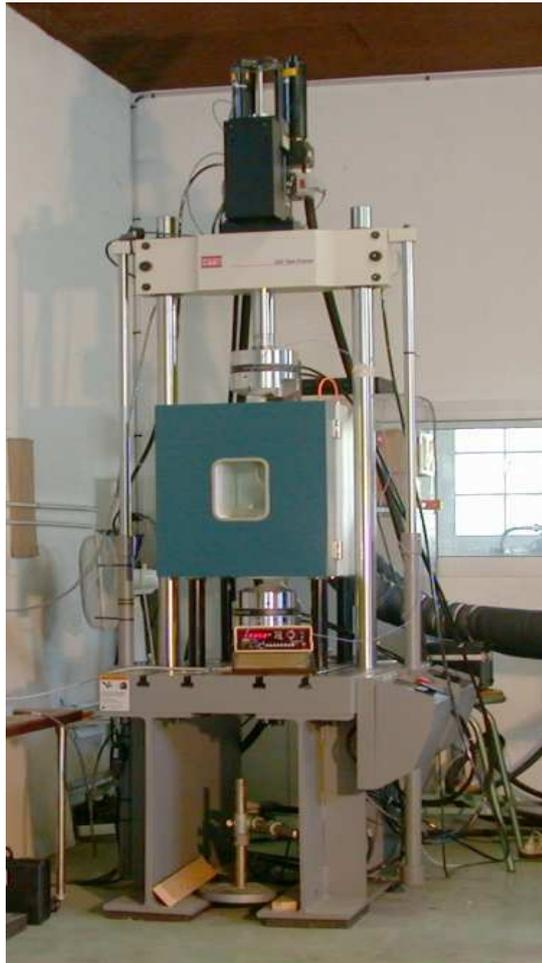
FIGURE III.9 – Machine d'essai avec enceinte thermique
