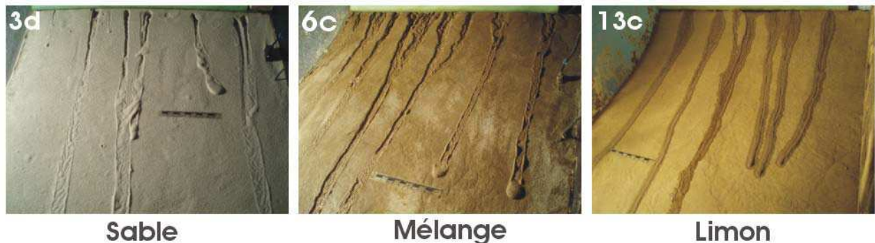
Figure VI- 12 : Gullies expérimentaux obtenus avec trois matériaux différents.
