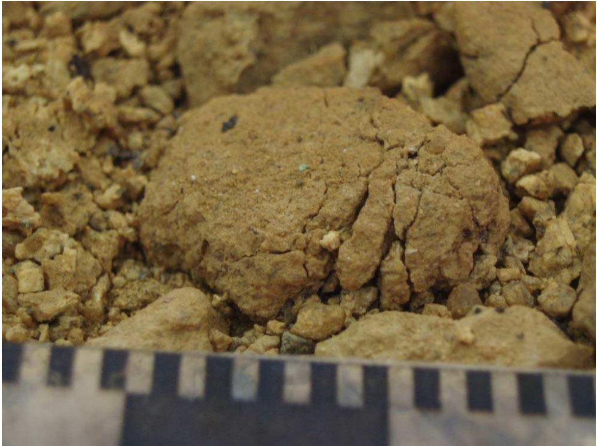
Figure 5 : gélifraction des éléments grossiers à la surface de l'échantillon.
