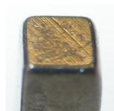
Figure 28 : Petite surface polaire après rectification
