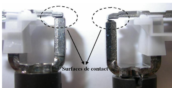
Figure 29 : Comparaison relais avec et sans rectification
