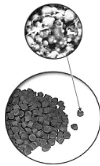
Figure 76 : Mélange de poudre métallique et de liant plastique
