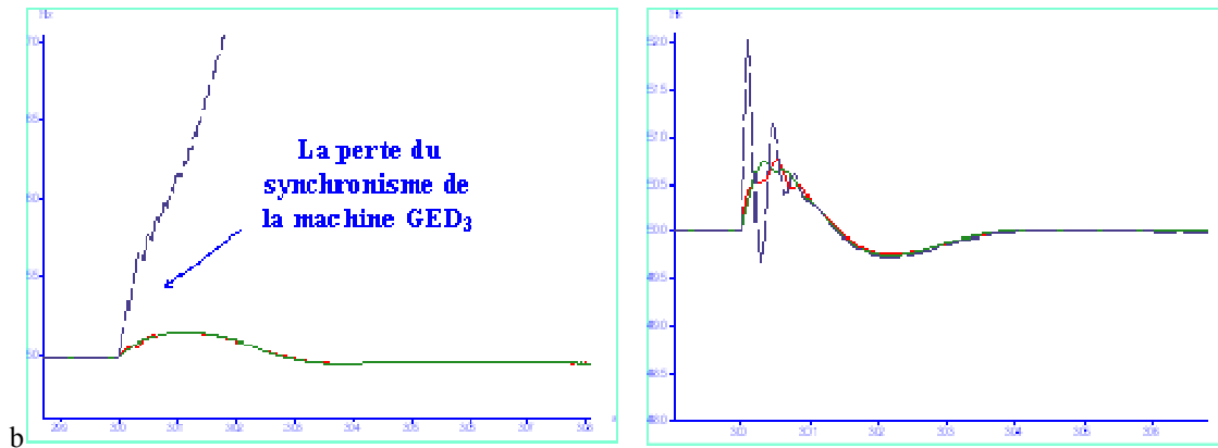
Figure. 4.23.- La vitesse de la machine GED 1 (rouge), GED 2 (vert) et GED 3 (bleu), dans le cas d'un court-circuit dans le nœud La Conq04, éliminé après 200 ms (gauche) et après 100ms (droite)
