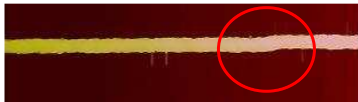
Figure 2-35 : Image AFM d'une ligne de résine réalisée par lithographie électronique montrant le décalage d'alignement dû à un mauvais raccordement de champ d'écriture.
