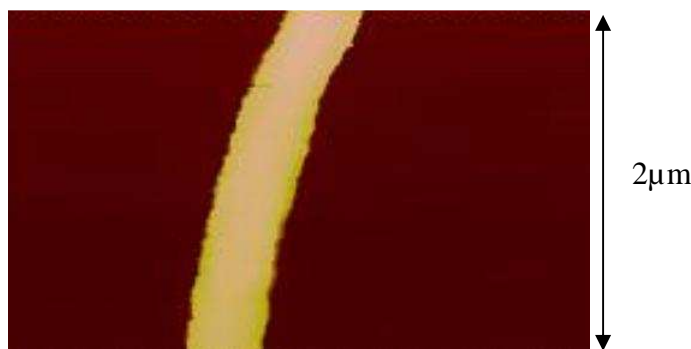
Figure 2-33 : Image AFM illustrant le décalage de la ligne par rapport à la fenêtre de mesure, dû à une dérive aléatoire du plateau de mesure.
