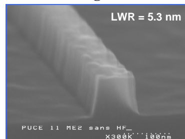
Figure 4-40 : Images MEB du flanc de la ligne après chaque étape technologique de fabrication d'une grille de transistor, réalisée à partir d'une stratégie de gravure avec un masque en Carbone
