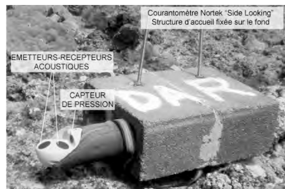
Figure V-1 : Courantomètre nortek side-looking fixé sur le fond.
