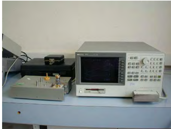
FIG. 6.14 – Analyseur d'impédance HP4291A connecté à une cellule coaxiale ouverte pour les mesures de permittivité des poudres.
