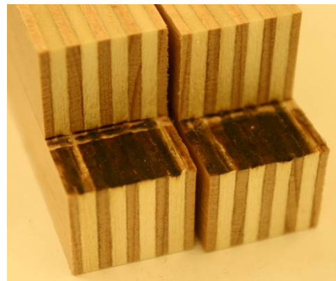
Figure 107: Test de cisaillement sur le contreplaqué non soudé (à droite) et soudé (à gauche) sur chant.
