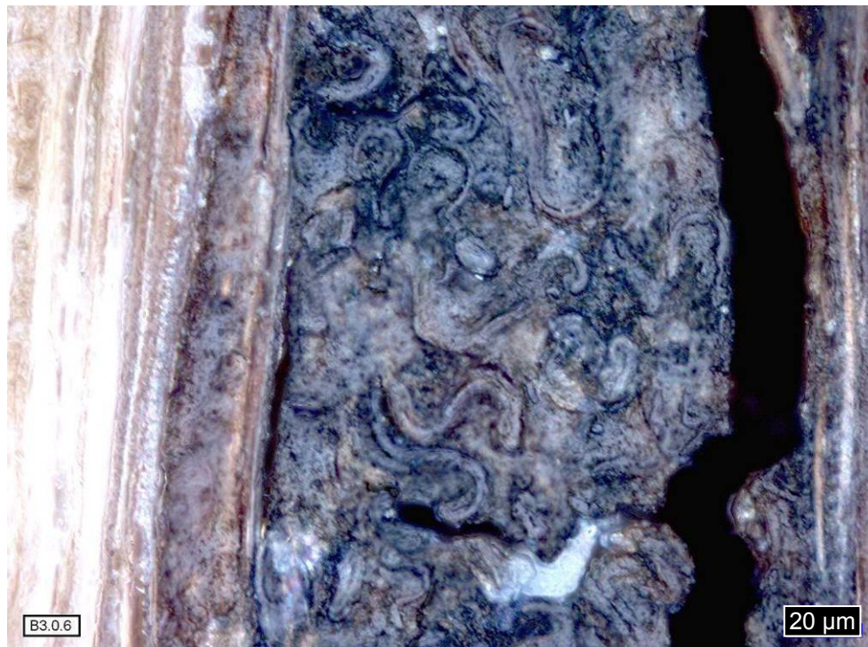
Figure 60: Observation à fort grossissement de la zone de soudage sur une coupe de type B (longitudinale) sur une pièce d' Acer campestre soudée.
