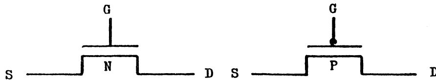
fig:III.26 Représentation symbolique des transistors a/transistor N, b/transistor P
