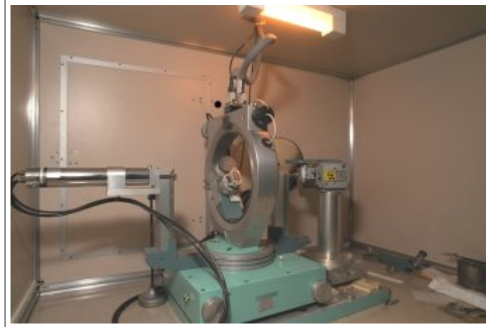
FIG. C.1 – Goniomètre de texture avec lequel les mesures ont été effectuées (LPTM - Université Paris13).
