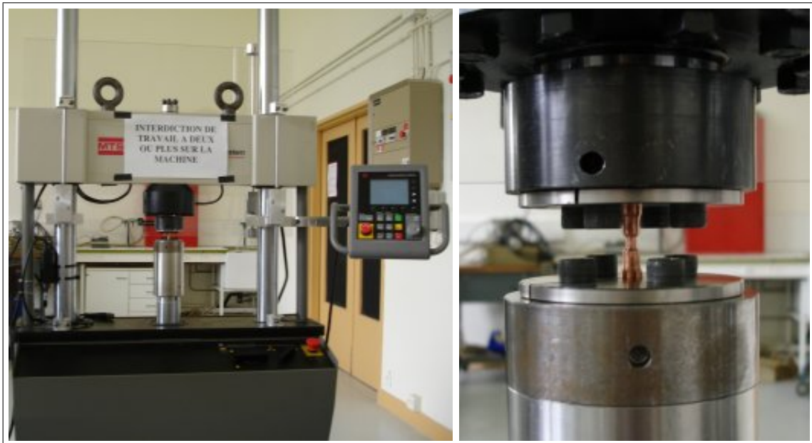
FIG. 6.2 – Essai cyclique de traction-compression sur machine de type MTS avec contrôleur Testar 2S, d'une capacité statique de 100 kN, avec un groupe hydraulique de 20 \text{ l.min}^{-1} .
