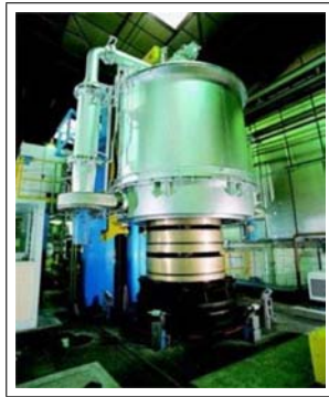
FIG. B.10 – Four cloche de recuit statique sous N 2 pendant 5 heures - Conception Griset.
